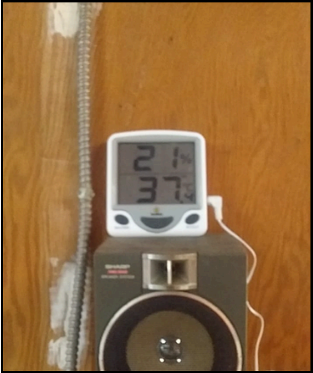
FIGURA 1: TERMÓMETRO REGISTRANDO LA HUMEDAD (LECTURA SUPERIOR) Y TEMPERATURA (LECTURA INFERIOR) EN EL INTERIOR DE UNA VIVIENDA PARA TRABAJADORES.
